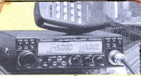
YAesu FT 5100 - Ricetrasmittente veicolare con Duplexer incorporato RxTx 144-148 MHz/430-440 MHz.
